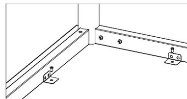
**2.1** Posicione os tampo e fixe com parafusos auto atarraxante
